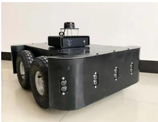
基于激光/惯导的搬运机器人系统
